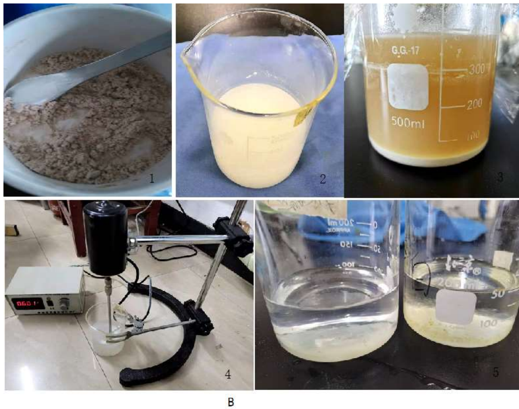
图 2 丁酸乙酯微囊制备工艺 (A) 丁酸乙酯微囊显微镜图; (B) 丁酸乙酯微囊的制备过程
