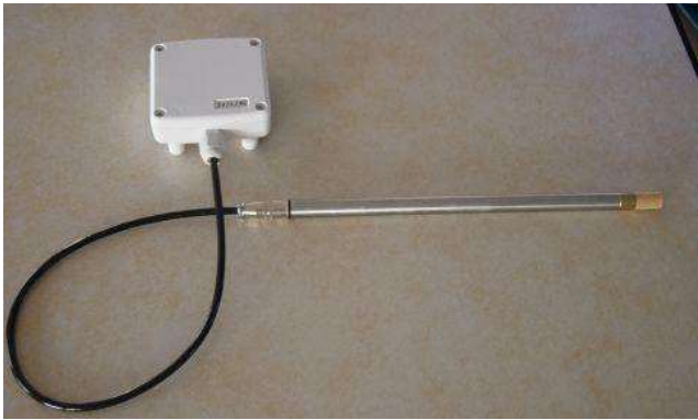
图 5 温度、湿度、光照和 CO 2 浓度显示器
