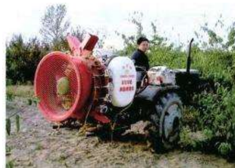
图 9 果园自动对靶静电喷雾机
